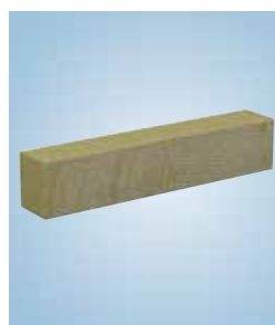
Płyta lamelowa z wełny mineralnej Płyta termoizolacyjna z wełny mineralnej zgodna z EN 13162. Duża wytrzymałość na odrywanie prostopadle do powierzchni płyty dzięki równoległemu ułożeniu włókien.
