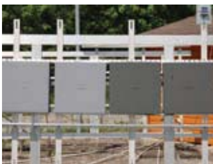
Tylko obraz termograficzny pokazuje różnicę: drugi i czwarty panel (od lewej) konstrukcji testowej pokryty jest farbą z pigmentem NIR. Odbija ona dużą część energii słonecznej, dzięki czemu powierzchnia panelu pozostaje znacznie chłodniejsza
